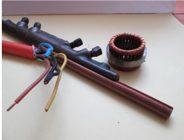
4. ábra Réz felhasználási példák: vezetőmag, kontaktvezeték, tekercstekercselés
