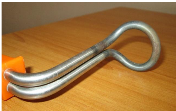
9. ábra Krómnikkel spirálvízmelegítő fűtőeleme
