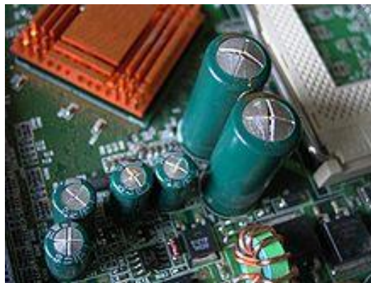
24. ábra Tönkrement elektrolitkondenzátorok (felhasadt a kondenzátor fedele)
