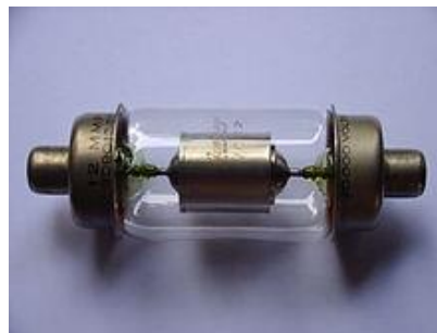
30. ábra 20 kV névleges feszültségű vákuumkondenzátor
