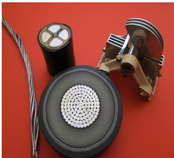
7. ábra Példák az alumínium használatára: AlFe köté, nagy keresztmetszetű vezetők, forgókondenzátor
