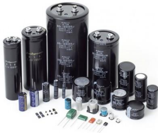
23. ábra Különböző méretű és kapacitású elektrolitkondenzátorok
