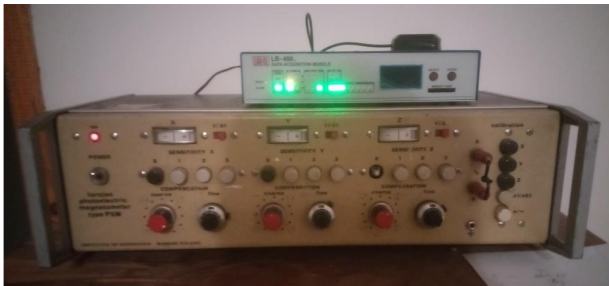
Obrázok 3 Záznamové zariadenie LB-480 pripojené na elektroniku magnetometra PSM-8711
