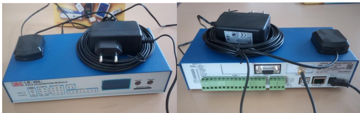
Obrázok 1 Predný (vľavo) a zadný (vpravo) panel zariadenia LB-480
