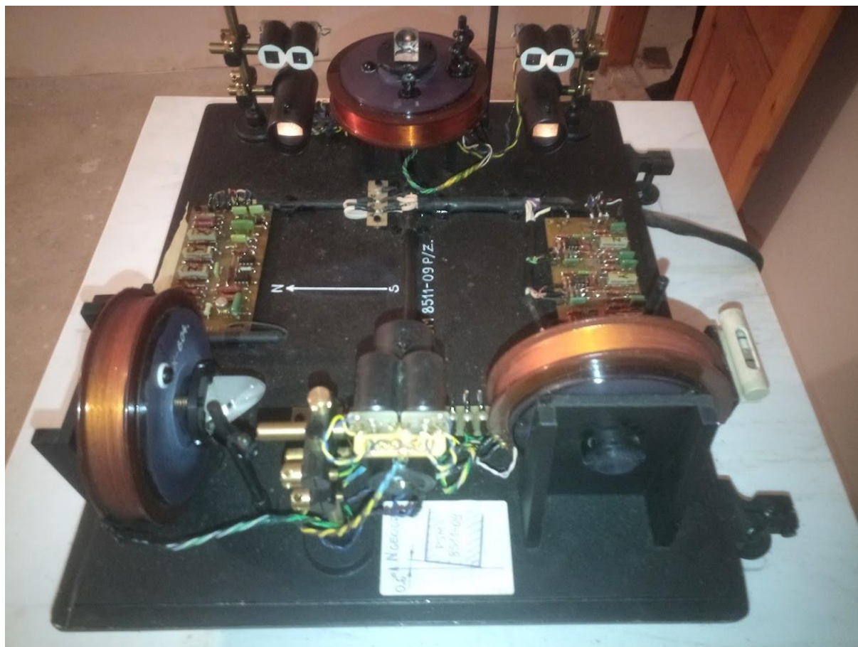
Obrázok 2 Sensorová časť magnetometra PSM-8711
