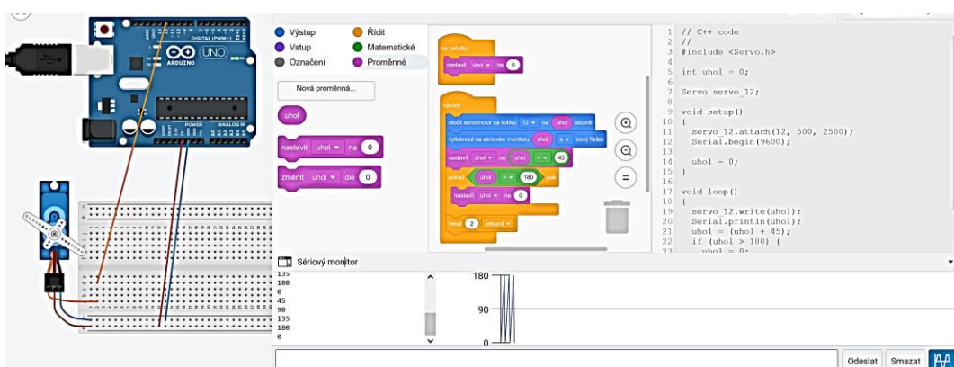
Obr. č. 5 Prvá úloha s motormi - nastavenie natočenia servomotora a použitie sériového portu
